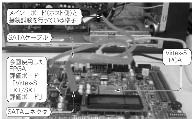
写真A FPGA 評価ボードをSATA デバイス(高速RAM ドライブ)として動作させている様子
