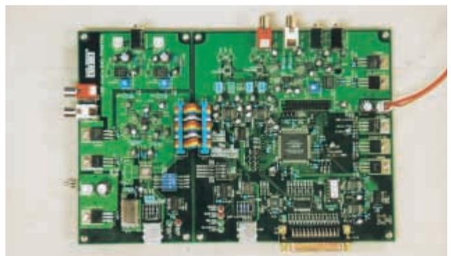
【写真1】評価用大規模PLDボード
