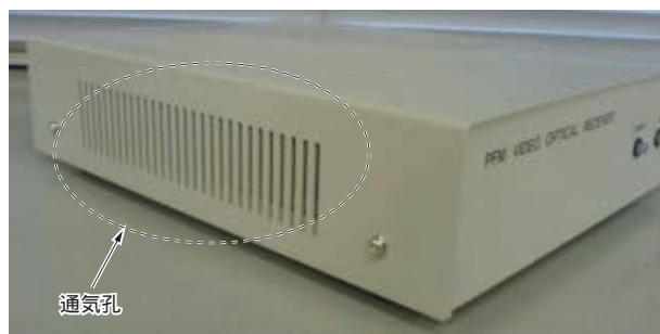
図1 自然空冷を行うためきょう体に穴を開けた電子機器
