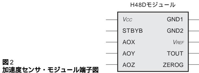
図2 加速度センサ・モジュール端子図
