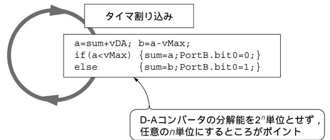
図3 PDM型D-Aコンバータのアルゴリズム
