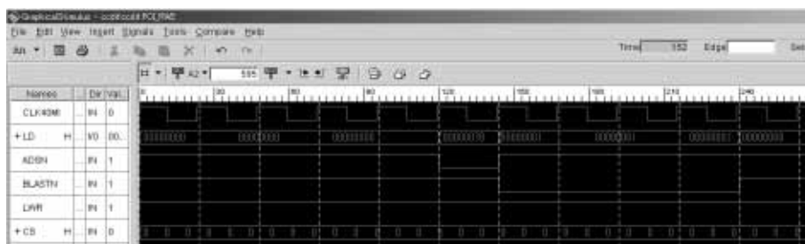
【図3】 シミュレーションを行うために作成した入力信号波形 PCIバスから78h番地に対する書き込み動作をシミュレーションしたものを。
