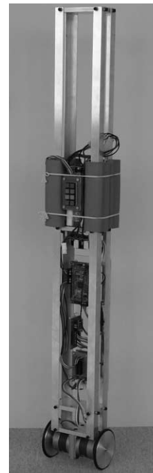
写真1 加速度センサと角速度センサを搭載した倒立振り子
