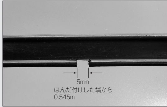
写真3-5 はんだ付けした端から0.545mのところに5mmの溝を入れる
