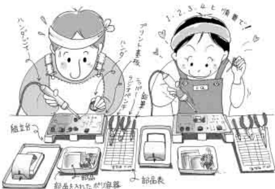
部品表のリストにしたがって、部品のリード線を基板の穴に差し、一つずつハンダ付けをしていく。穴の位置を間違えたり、違う部品を付けてしまわないように注意しながら組み立てる。特に極性のある部品は取付方向に注意
