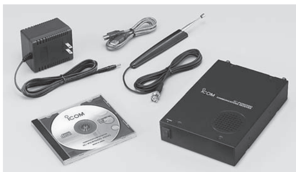
受信操作をパソコンに任せてしまうのがSDRの特徴。写真はアイコム(株)のIC-PCR2500
