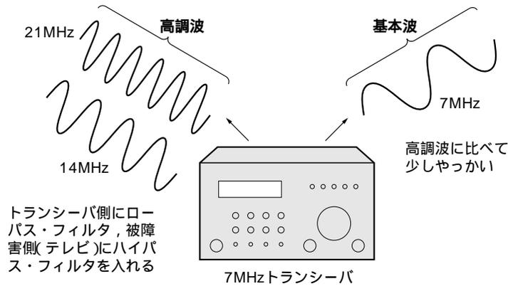
図3-1 「基本波による障害」と「高調波による障害」を区別する
