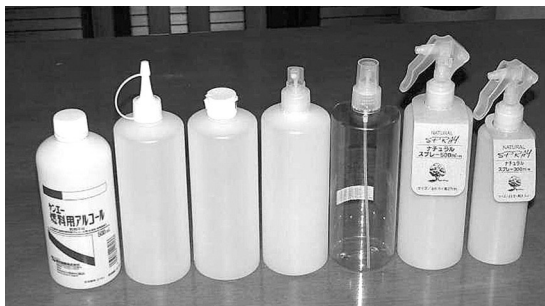
写真2 コイルのボビンに適した500ml PEボトル
