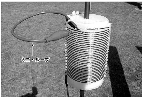
写真1 7MHz用コイルにミニ・ループ(短絡リード線)を付けた
