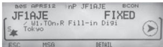
写真2-9 受信割込画面でDETAILを押すと、詳細情報を表示
