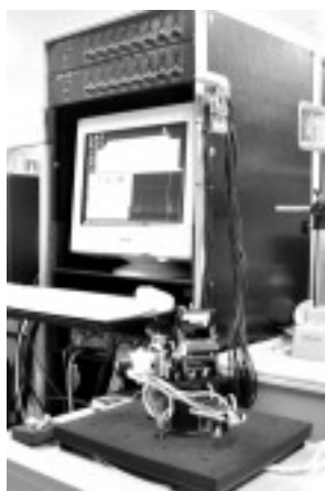
図4 監視ロボット Einstein の外観
