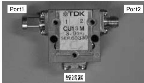
って、マイクロ波帯用のコンポーネントを測定してみます。最初に、アイソレータ (isolator) というデバイスの高周波特性を測定してみます。外観を写真1・6に示します。アイソレータは、ポート1からポート2には信号を通しますが、逆方向には信号を通しません。理想的な50 Ω系のアイソレータは図1・4に示すような性能を有します。
