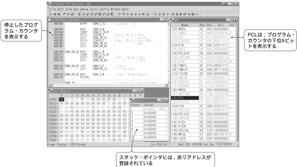
図4-12 任意に停止した場合の表示 ソース・プログラム画面には停止位置のプログラム・アドレスが表示され、SFR、データ・メモリ、スタック・ポインタ画面には現在の値が表示される。
