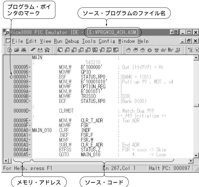
図4-3 ソース・プログラムの画面 ソース・プログラムの編集画面で、アセンブラを実行するとメモリ・アドレスが表示される。
