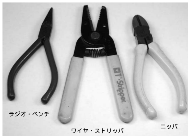
写真1-1 今回使用したツール 最近購入したニッパ、ラジオ・ペンチ、ワイヤ・ストリッパは20年前に購入したもの。
