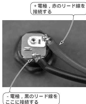
(g) センタ側をプラスにするDCジャックの接続
