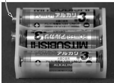
(c) 乾電池を電源として利用する場合 回路テストなどでは、1.5V×3で4.5Vの電源として利用できる。
