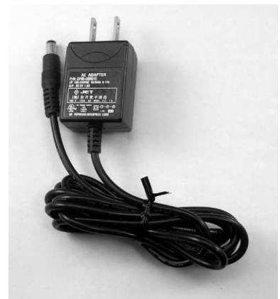
(b) 5V出力の安定化されたACアダプタ スイッチング・レギュレータが内蔵されており、5Vの安定化された出力が得られる。プラグは内径2.1mmのものを選ぶ(内径2.1mmが一番一般的なもの)。
