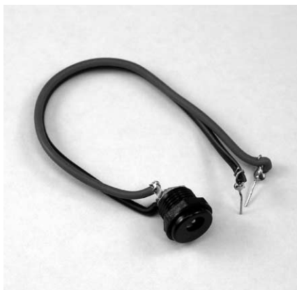
(f) ACアダプタのプラグを受けるDCジャック パネル取り付け型のDCジャックにリード線とブレッド・ボード用のスズ・メッキ線のピンを追加する。
