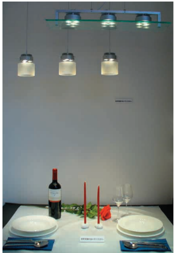
(b) 日立ライティングの高輝度LEDペンダント…1ユニット当たりパワーLEDを3個使用。ビーム角は25°。白色と電球色をそろえる。全光束は810lm(白色)、630lm(電球色)。消費電力は27W。光束維持率70%における推定寿命は30000時間
