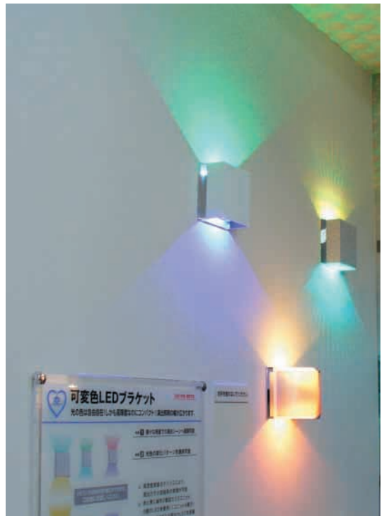
(f) 日立ライティングの変色LEDブラケット…1ユニットは赤1個と青1個, 緑を2個で構成. 1台当たり2ユニットを使用. 消費電力は最大10 W. 白色時の全光束は200 lm
