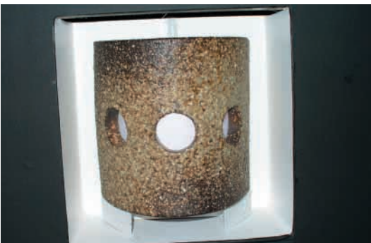
(g) タカショーデジテックの和風LEDライト…同社製「ローパワーLEDモジュール」を使用. 暴雨構造. 消費電力は0.36 W. 白および電球色を用意. 1/fゆらぎもあり
