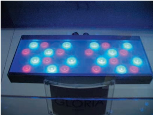
(c) ファーストシステムのLED照明「GLORIA」…直流24 V, 50 W. 光角40°
