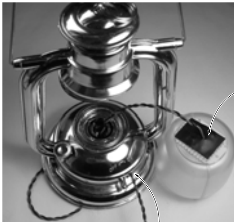
写真4-9 絶縁シートを貼った基板からのケーブルを配線
