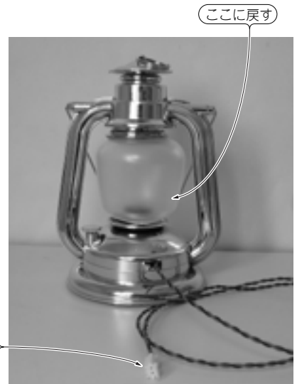
写真4-10 LED内蔵ランプ型ライトの完成
