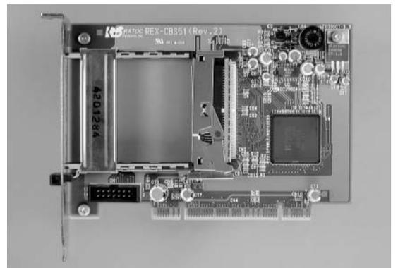
(b) CardBus対応32ビットPCIC搭載 (PCIバス用)
