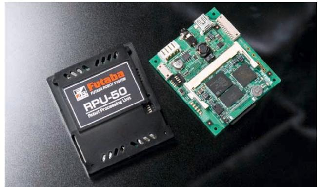
写真2 制御用プロセッサ・ボードRPU-50
