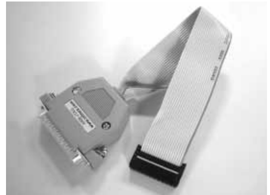
写真1 ARMに対応したパラレル・ポート・タイプのJTAGアダプタ ARM-JTAG
