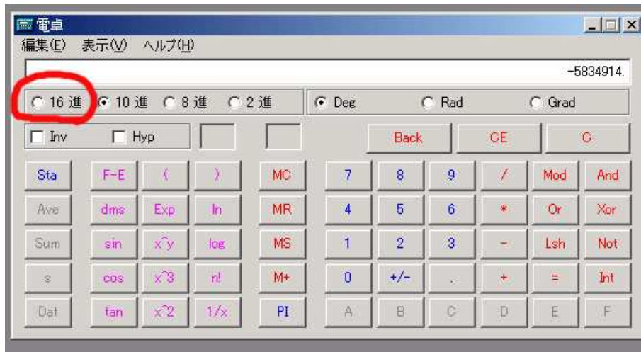
図 7: Windows の電卓を 16 進数モードにする
