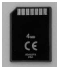
写真10-2 MultiMediaCard (MMCカード)の外観
