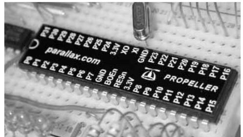
写真1 Propellerの外観(40ピンDIP型)
