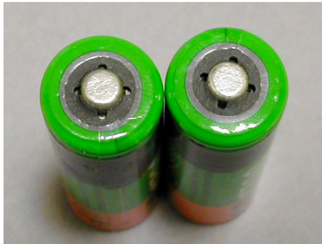
図4 ニッケル水素電池の頭部（単三型）
