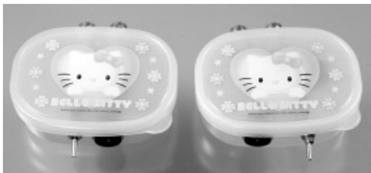
〈写真7-1〉製作したTDR用高速パルス信号源(左:その1, 右:その2)
