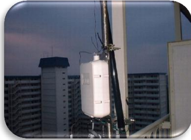
ほぼ垂直に立てた給電点39mHの釣り竿ホイップ (6.3mと10mを使い分ける) . AH4とマニュアル・ チューナの併用しアースは建物のてすり Txn JR1GJP
