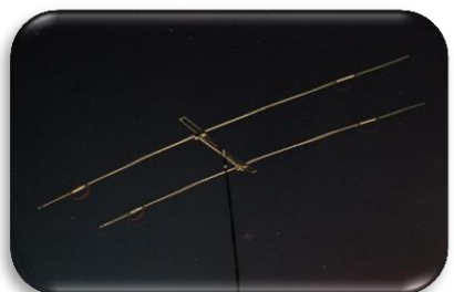
14/21/28MHz用の2エレHB9CVのトラップ・コイルの 両端を短絡させアンテナ・チューナを使って18MHzに QRV Txn JL3LSF
