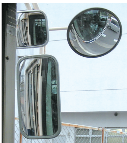
写真1 バスに取り付けられた複数のミラー……死角を補っている バスの内側から撮影した。
