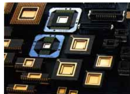
〔写真2〕 多ピン・パッケージの例
