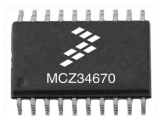
写真 A Power over Ethernet 受電 IC MCZ3467
