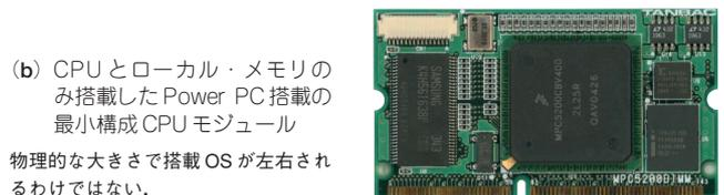
(b) CPU とローカル・メモリのみ搭載した Power PC 搭載の最小構成 CPU モジュール
