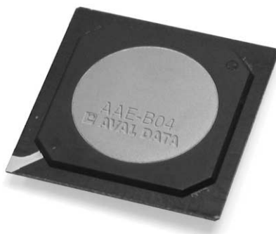
写真1 今回作成した LSI の 外観 アバルデータ製の PCI Express bus Bridge 「AAE-B04」。
