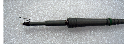
写真4 パッシブ・プローブに高速信号用グラウンド・クリップを装着した様子
