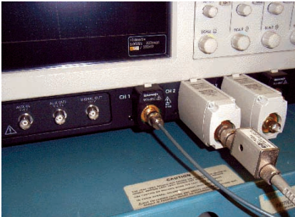
写真2 オシロスコープの50Ω入力同軸ケーブルをつないでいる様子。
