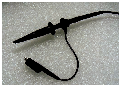
写真1 500MHz 帯域パッシブ・プローブの例 パッシブ・プローブでは実質最大となる 500MHz の周波数帯域に対応する。
