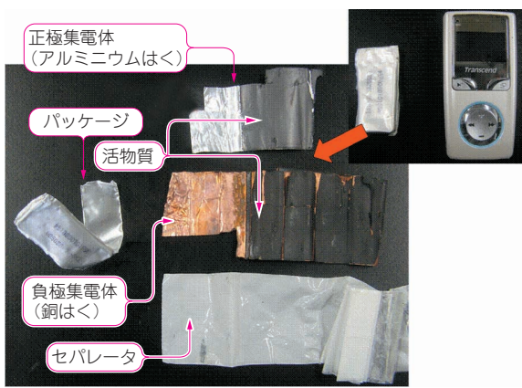
写真2 リチウム・イオン電池パックの分解写真 集電体、活物質、電解液、セパレータの四つに分けられる。
