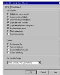
Electrical Rule Check ダイアログボックス マトリックステーブルを使って条件の設定を行う。
