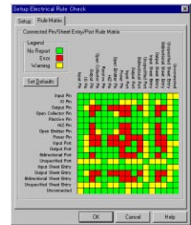
Electrical Rule Check ダイアログボックス マトリックステーブルを使って条件の設定を行う。
