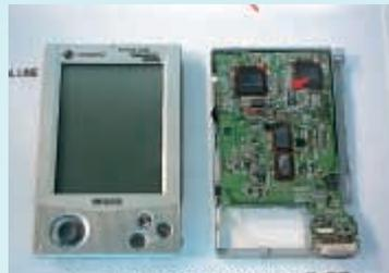
〔写真C〕 ノイズ対策部品の実装例
