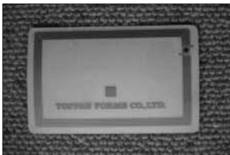
〔写真1〕非接触 IC カード (RFID タグ) の内部 アンテナの右上に数 mm 角の IC チップがある (トッパン・フォームズ提供)。
