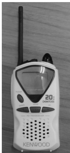
◀写真2 特定小電力のトランシーバの例
