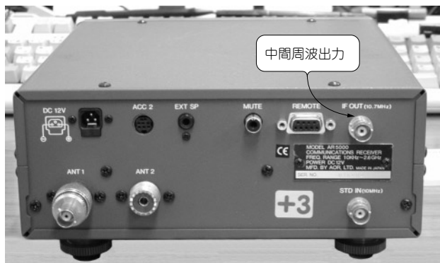
▶写真3 中間周波出力のあるレシーバの例 エーオーアールの広帯域レシーバ
