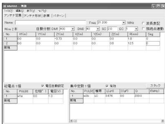
JA6GAN 製作の 21MHz マイクロバート・アンテナの MMANA モデル・ファイル
