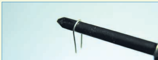
写真3-22 先端で円弧を作りU字状に加工する
