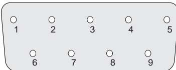
図4-4 RS-232Cのピン・アサイン(9PIN) 1: CD 2: RxD 3: TxD 4: DTR 5: GND 6: DSR 7: RTS 8: CTS 9: RI
