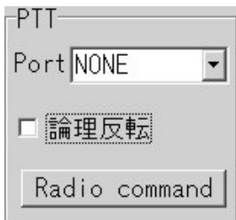
図4-6 PTTのPortがNONEになっている場合は、ここで設定を変更できる
