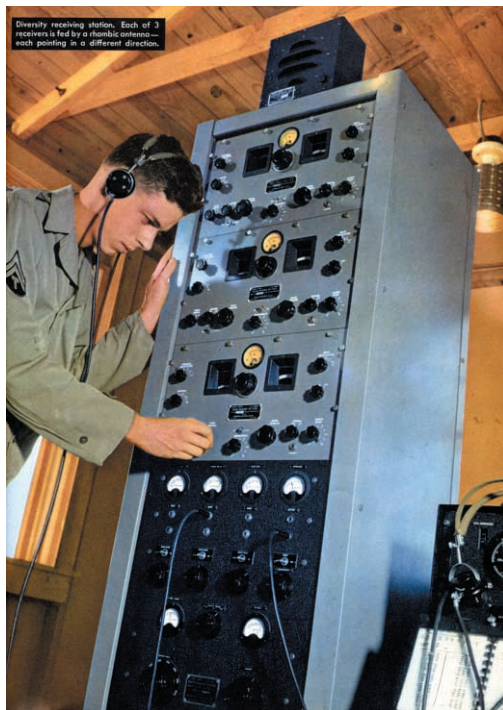
受信機を3台使用したダイバシティ受信システム。カラー写真は珍しい
