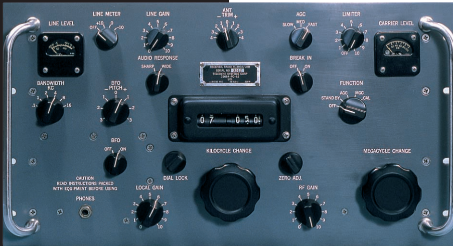
カウンタ・ダイヤルを中央に据え、キャリアとオーディオ・メータを左右に配したメカニカルなパネル面
