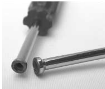
(a) 工具が悪いとシャーシに写真のような円形のキズが付いてしまうので要注意！ (b) シャーシに傷をつけないように加工されたボックス・ドライバ
