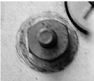
(a) 工具が悪いとシャーシに写真のような円形のキズが付いてしまうので要注意！ (b) シャーシに傷をつけないように加工されたボックス・ドライバ
