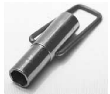
写真4-4 パネル表面から沈められたポリウムなどの取り外し、取り付けに重宝なボックス・レンチ
