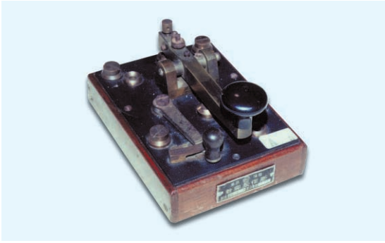
写真13 逓信省型 中継電鍵 (有線用) 逓信省仕様 仕第247号により、音響モールス二重通信用として明治 - 大正 - 昭和30年頃まで使用されたが、電報サービスの機械化により姿を消した。「新興製作所：のちの谷村新興」の銘板があり、二重通信用のスイッチが付いている。
