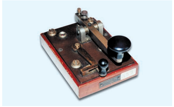
写真14 逓信省型 中継電鍵 (有線用) 写真13と同様だが、本品は一回り小さな仕様となっている。全国の電報電話局のほか、自営有線回線用としても使用された。「仕第247号、昭和23年用賀精工社製造」という銘板が付いている。
