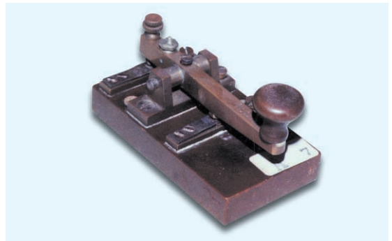
写真16 逓信省型 交換打ち合わせ用単流電鍵 (有線用) 逓信省型甲種単流電鍵よりひと回り小さい。市外電話交換と中央電話局間の二重信という音響式モールス連絡回線に、電話交換手が電話回線接続の打ち合わせに昭和20年代頃まで使用していたもの。
