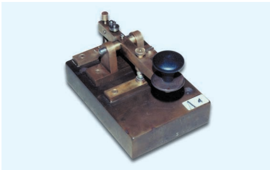
写真15 逓信省型 信号用電鍵 (有線用) 構造的には逓信省型甲種単流電鍵と同様だが、接点がきわめて太く、堅牢な作りとなっている。戦前に発光信号断続用として使用されたもの。沖電気製。
