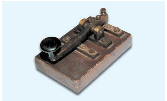
写真18 逓信省型 練習用電鍵 (無線用) 本品も銘板はないが、昭和30年頃くらいまで無線従事者養成校で練習用として使われたもので、本来は有線用のもの。大きさは写真5とほぼ同等。
