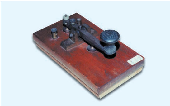
写真17 逓信省型 練習用電鍵 (無線用) 外観は、写真7と同じだが、戦前に無線従事者養成校で練習用として使われたもので、有線用のものを流用している。この形状のものは、写真7、写真9、写真10、写真11と各用途ごとに多少のバリエーションがあるものの、基本構造などは同様。
