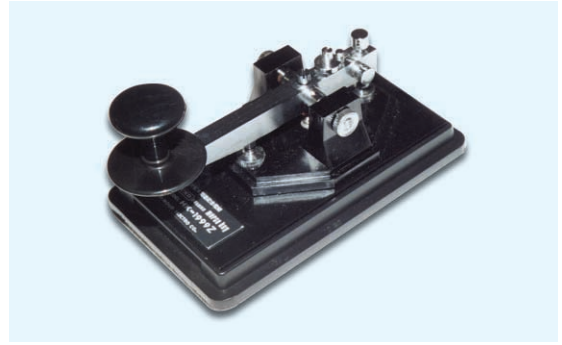
写真26 HI-MOUND樹脂台HK-1999Z型電鍵(無線用) 前世紀最後のミレニアム樹脂台電鍵で、現行品種。いわば写真25に示す姉妹編にあたるもので、機構部は甲種単流電鍵のものを流用し、支柱部は旧HK-1Z, HK-1S, HK-3, HK-8のものを流用し、樹脂台の上にコンパクトにマウントされている。
