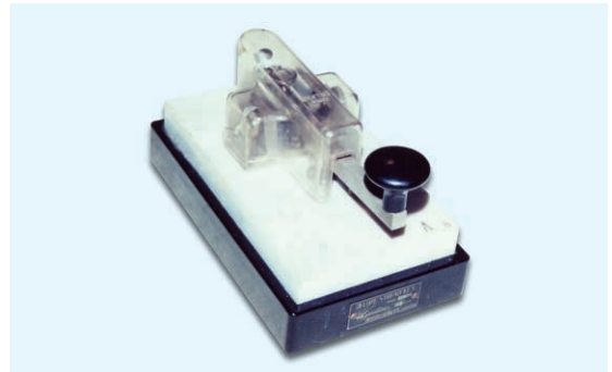
写真30 SWALLOW 電通精機製旧型HK-1S型電鍵(無線用) 写真27の旧型で、銀接点がφ6mmと比較的太く、大電流のキーイングが可能で、発光信号用としても使用できる。大理石台の下は黒色モールド台を使用し、アクリル防塵カバーの形状が新型と異なっている。
