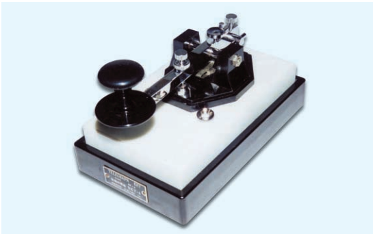
写真29 HI-MOUND HK-8型/NKY-4電鍵(無線用) 銀接点がφ2mmと比較的細く、歯切れのよいキーイングができる。海上自衛隊仕様NKY-4型に相当し、大理石台のズシッとした重量感があり、かつての海岸局、船舶局などの標準装備品となっていた。
