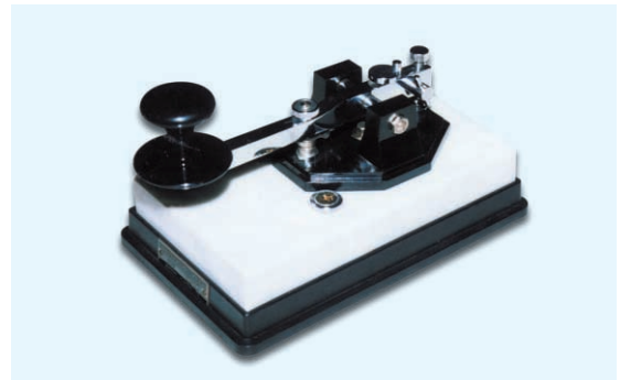
写真28 HI-MOUND HK-1Z型電鍵(無線用) 銀接点がφ6mmと比較的太く、前部上接点の取り外しと調整が可能な構造となっている。本品の大理石の下は後期モデルで、黒色ABS樹脂を使用している(前期モデルは写真27同様、黒色モールド台を使用)。接点が大きいため大電流のキーイングが可能で、発光信号用としても使用できる。
