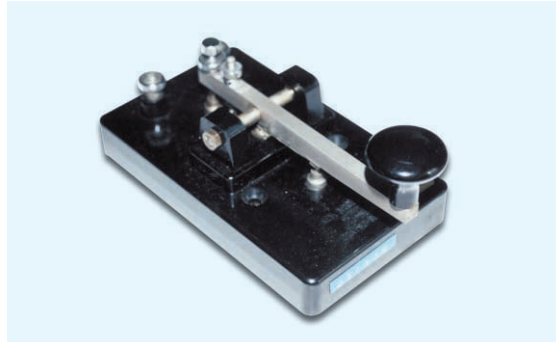
写真38 SWALLOW 電通精機製HK-5型 空自HK-7)STREAM KEY(無線用) モールド台の汎用普及型キーで、練習用として各養成校でも使用 された。接点は歯切れのよい 2mmのタングステン鋼を使用。 当時のカタログによれば、別名の空自仕様 HK-7として航空自衛 隊でも使われた。
