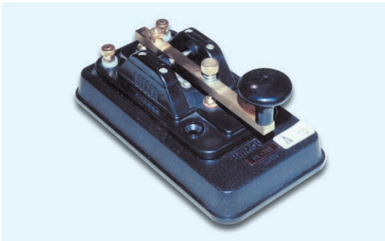
写真41 HI-MOUND HK-705型 練習電鍵（練習用） コストを抑えた初級練習用キーで、耐久性を重視した設計となっ ている。接点は 3mmの真鍮である。
