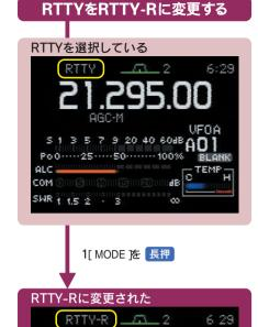
RTTY信号が正しく復調できないときは、RTTY-R(リバース)モードに変更することにより、リバース信号に対して受信機側で極性を合わせることができるまた 受信BFOを反転させるので 近接の混信を軽減できる場合がある
